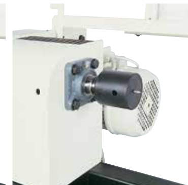
Trascinatori a Coppa diametro 40 mm e a vite diametro 70 mm realizzati in acciaio monoblocco sono indispensabili per tornire piccole coppe.
