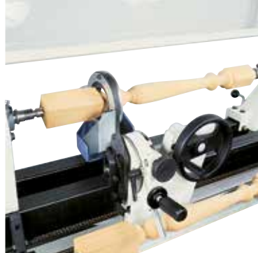
Gruppo Copiatore. Permette di riprodurre pezzi con diametro diverso dall'originale. Avanzamento a mezzo volantino manuale.
