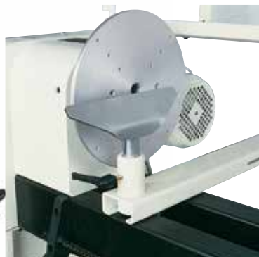
Platorello diametro 300 mm, utilizzato per realizzare grandi coppe.
