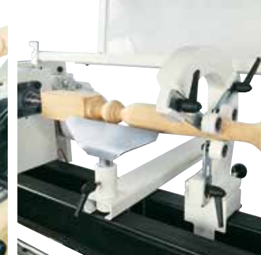
Lunetta Fissa , utilizzata per ridurre le vibrazioni di pezzi lunghi e sottili. La configurazione a "C" permette il passaggio di un utensile a mano.
